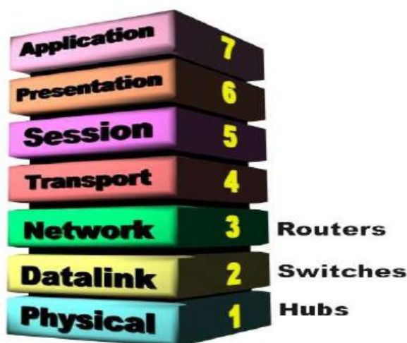
Εικόνα 1.2: Ο router στα 7 επίπεδα του μοντέλου αναφοράς OSI (2000, How staff works).
