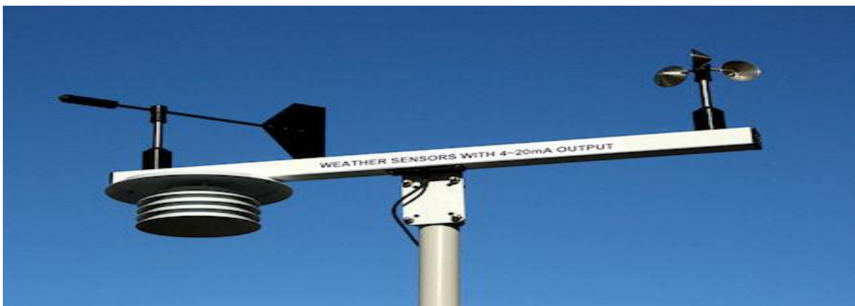
Σχήμα 7: Αισθητήρας μέτρησης ταχύτητας και διεύθυνσης ανέμου.
