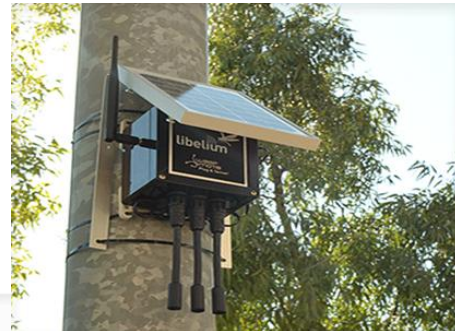
Εικόνα 4:Ηλιακοί αυτόνομοι τροφοδοτούμενοι αισθητήρες Plug & Sense
